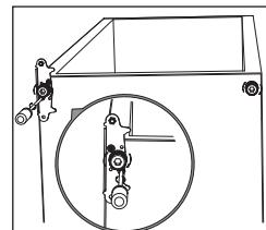
8. Otočte střední závěs o 180°, poté jej přesuňte na levou stranu. Zasuňte kolík středního závěsu do horního otvoru spodních dveří a dotáhněte šrouby.
