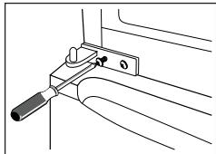
9. Nasadte horní dveře zpět. Než definitivně zašrouujete horní závěs, zkонтrolujte, zda dveře horizontálně i vertikálně líčují a zda těsnění po všech stranách správně dosedá. Poté přiložte závěs a zašrouujte jej do horní části spotřebiče.
