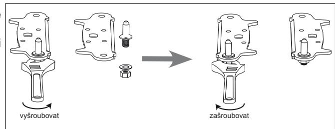
7. Nasadte konzoli na kolík spodního závěsu. Vratěte zpět obě nastavitelné nožky. Spodní dveře přesuňte na požadovanou pozici.
