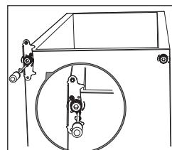
8. Otočte stredný záves o 180 °, potom ho presuňte na ľavú stranu. Zasuňte kolík stredného závesu do horného otvoru spodných dverí a dotiahnite skrutky.
