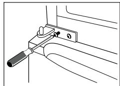
9. Nasadťte horné dvere späť. Než definitívne zaskrutkujete horný záves, skontrolujte, či dvere horizontálne aj vertikálne doliehajú a či tesnenie po všetkých stranach správne dosadá. Potom priložte záves a zaskrutkujte ho do hornej časti spotrebiča.
